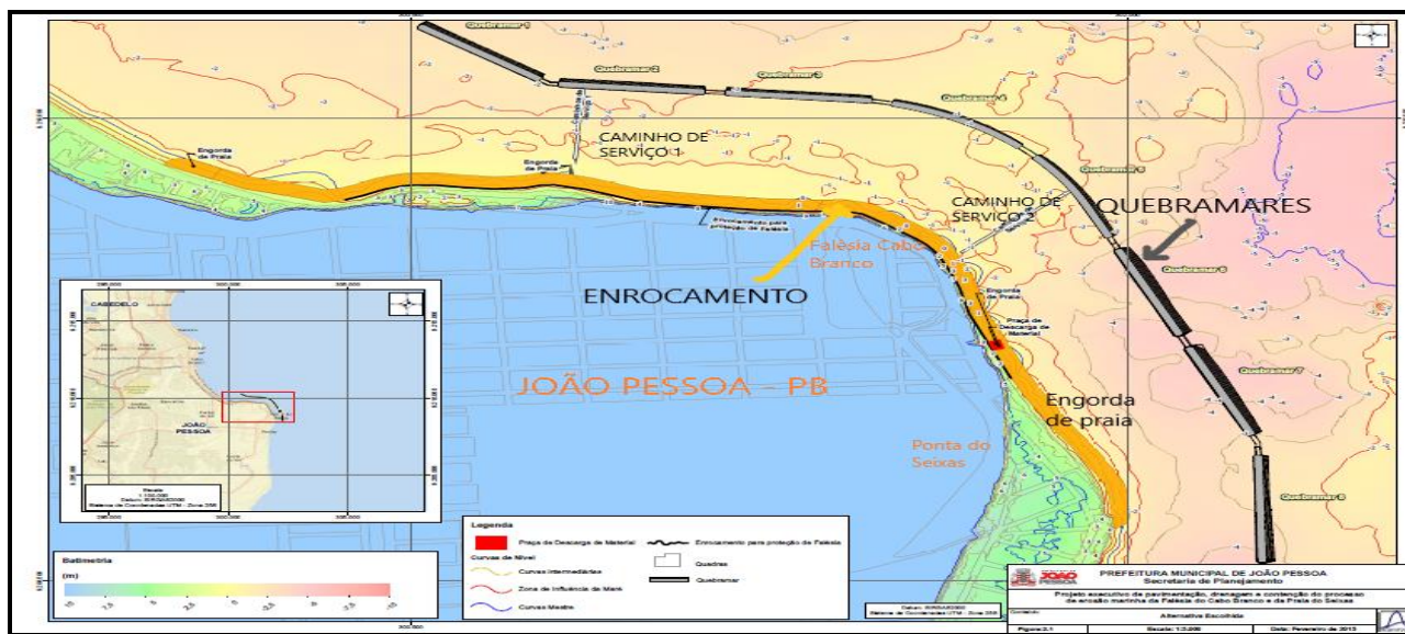
Fig.1: Mapa de João Pessoa – Falésia Cabo Branco e Ponta do Seixas – Metas (Soluções Aprovadas: enrocamento, engorda de praia, 8 quebra-mares)
